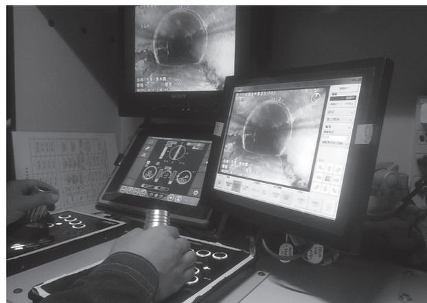
地上でモニター越しにTVカメラを操作します。
